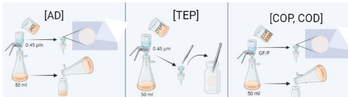
Figura 5. Recolección y filtrado de muestras para análisis de AD, TEP, COP y COP.
